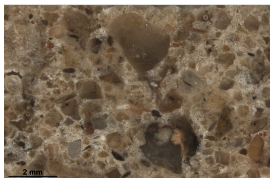
Mortier vu à la loupe binoculaire
